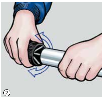
2 Usunąć zadziory z wewnętrznej i zewnętrznej krawędzi rury.
