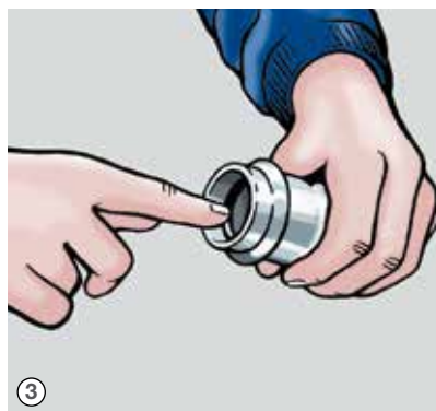
3 Sprawdzić, czy element uszczelniający jest prawidłowo osadzony.
